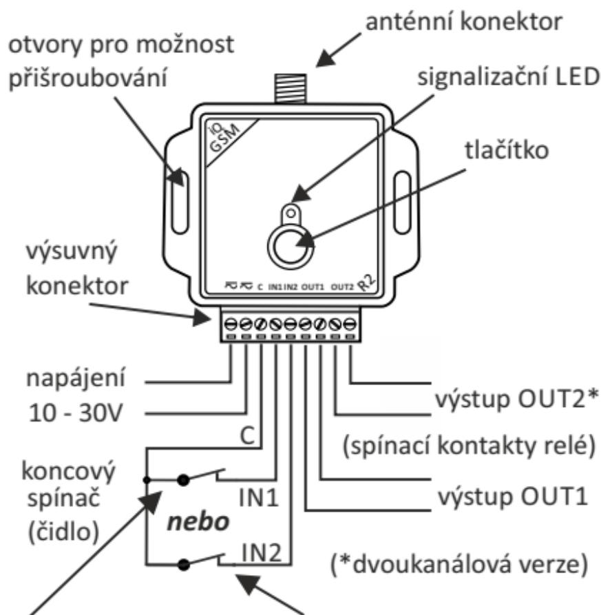
Koncový spínač brány se zapojí na svorky IN1 a C. Alarm je vyvolán vždy, když je překročen nastavený čas otevření.
